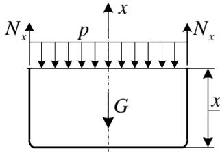
Das Gewicht der Flüssigkeit im dargestellten Behälterteil:  $G = (R_0^2 \pi x) \gamma$ .
