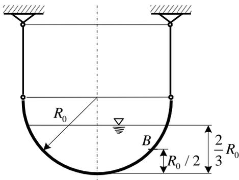
Gegeben: die Meridiankurve der Mittelfläche eines Halbkugelbehälters und die Dichte / das spezifisches Gewicht der Flüssigkeit:
