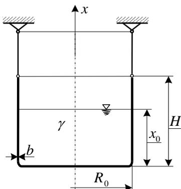
Gegeben: die Abmessungen eines Kreiszyliner-Behälters mit senkrechter Rotationsachse und die Dichte / das spezifische Gewicht der Flüssigkeit:
