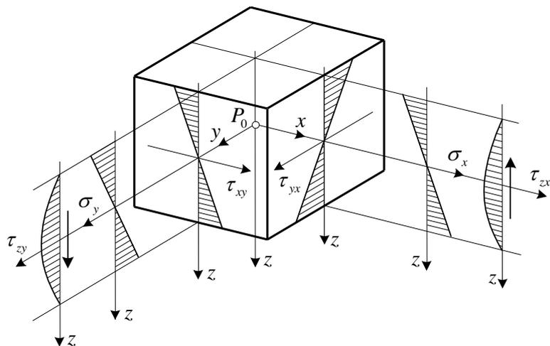
c) Berechnung des Spannungstensors im Punkt  $z = -b/4$ :
