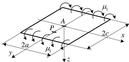
Die Rechteckplatte mit der Dicke  $b = 20 \text{ mm}$  ist an ihren parallelen Seiten mit den Linienmomenten  $\mu_1$  belastet. Die Durchbiegung der Mittelfläche wird mit der Funktion  $w_0 = C_1 x^2 + C_2 y^2$  bestimmt.
