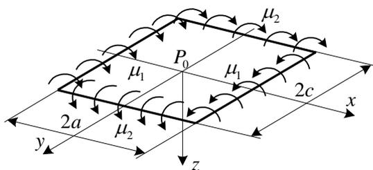
Die Rechteckplatte mit der Dicke  $b = 30$  mm ist an ihren parallelen Seiten mit den Linienmomenten  $\mu_1$  belastet. Die Durchbiegung der Mittelfläche wird mit der Funktion  $w_0 = C_1 x^2 + C_2 y^2 + C_3 xy + C_4 x + C_5 y + C_6$  bestimmt.
