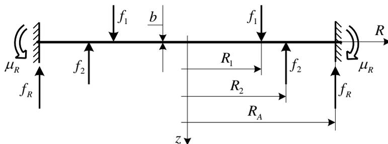
Gegeben: Die Abmessungen und die Belastung einer Kreisplatte:
