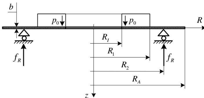
Gegeben: Die Abmessungen und die Belastung einer Kreisringplatte:
