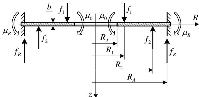
Gegeben: Die Abmessungen und die Belastung einer Kreisringplatte:
