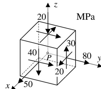
c) Berechnung des Spannungsvektors  $\vec{\rho}_n$  und der Spannungskordinaten / Spannungskomponenten
