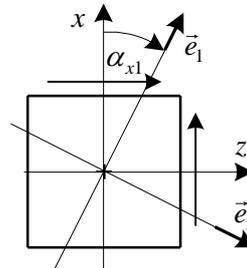
d) Bestimmung der Verzerrungszustandes im Punkt *P*, Veranschaulichung des Verzerrungszustandes mittels des elementaren Dreibeines:
