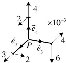
Gegeben: Der spezifische relative Verschiebungszustand des Punktes  $P$  mit dem elementaren Dreiein.
