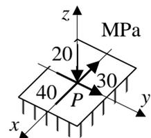
b) Veranschaulichung des Spannungszustandes im Punkt  $P$  mittels des elementaren Würfels:
