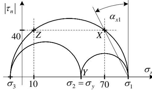
c) Bestimmung der Hauptspannungen und Hauptrichtungen aus dem *Mohrschen* Kreisdiagramm:
