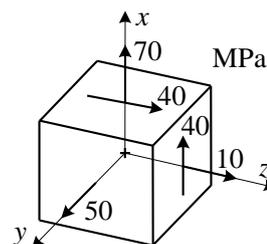
b) Veranschaulichung des Spannungszustandes im Punkt  $P$  mit dem *Mohrschen* Kreisdiagramm:
