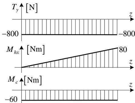
Reduktion der Belastung auf die Mittellinie der Welle:
