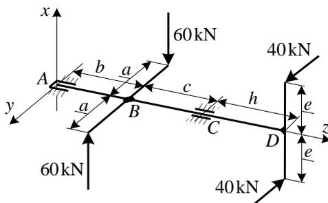
Gegeben: Die Abmessungen des eingespannten Tragwerkes ABCD mit einem Kreisquerschnitt:  $a = h = 0,2 \text{ m}$ ,  $b = 0,4 \text{ m}$ ,  $c = 0,5 \text{ m}$ ,  $e = 0,3 \text{ m}$  und  $n_F = 2$ ,  $\tau_F = 160 \text{ MPa}$ .
