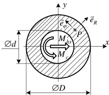
Gegeben: Die Beanspruchung des kritischen Querschnittes eines Trägers mit einem Kreisringquerschnitt (einer Rohrwelle)  $\vec{M}_S = (600\vec{e}_x + 800\vec{e}_z) \text{ Nm}$ , sowie  $\sigma_{zul} = 80 \text{ MPa}$ ,  $D = 2d$ .
