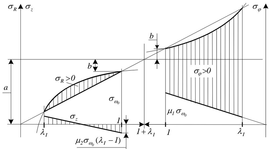
c) Ermittlung der Matrix des Spannungstensors in Zylinder-Koordinaten  $R, \varphi, z$  an den Punkten  $R_A = D_A/2$ :
