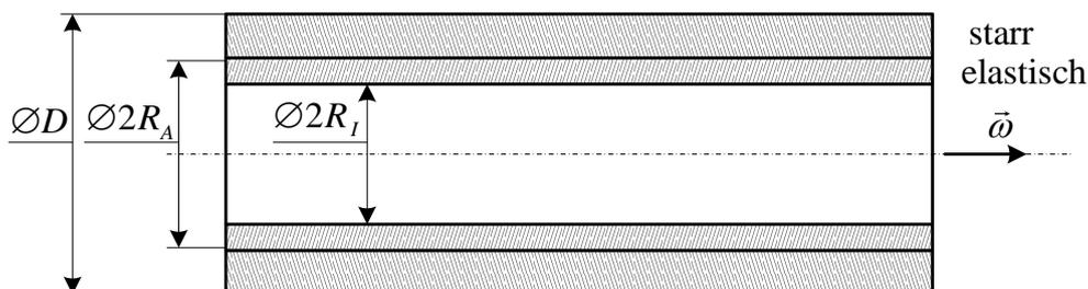
Gegeben: Das äußere Rohr / die äußere Rohrwand ist starr, das innere Rohr / die innere Rohrwand ist elastisch. Die Rohre / Rohrwände sind ohne Überlappung zusammengesetzt. Das so aufgebaute
