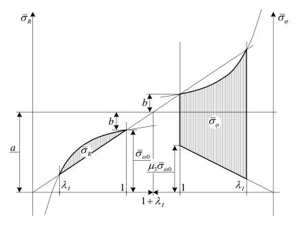
Charakteristische Spannungswerte:  $\overline{\sigma}_{\varphi}(\lambda = 1) = 5.7 \text{ MPa}$ ,  $\overline{\sigma}_{\varphi}(\lambda_{\tau}) = 25.46 \text{ MPa}$ .
