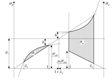
b) Ermittlung der Matrix des Spannungstensors in Zylinder-Koordinaten an der Stelle  $R = R_A$ : Durchschnittsspannungen:
