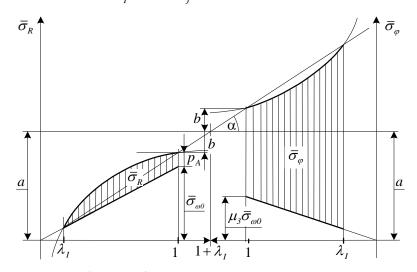
Ermittlung der Konstanten a und b:  $tg\alpha = \frac{\left(\overline{\sigma}_{\omega 0} + p_A\right) - \overline{\sigma}_{\omega 0}\lambda_I}{1 - \lambda}$
