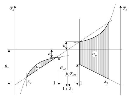
b) Untersuchung, wie die maximale Drehzahl vom Durchmesser der Bohrung abhängt.
